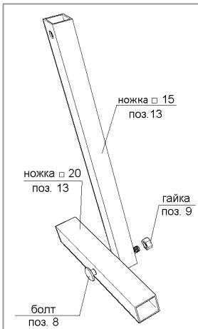
5.2.1. Соберите Т-образные ножки для крепления теплицы в грунт как показано на рис. 4.
