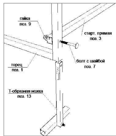
5.2.2. Соедините болтами 6x50 мм собранный торец со стартовыми прямыми при этом закрепив ножки в нижней части торца согласно просверленных отверстий (рис. 5).
